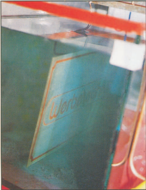
Galvanisches Ätzen: das Schild hängt in der mit Schwefelsäure angereicherten Kochsalzlösung
