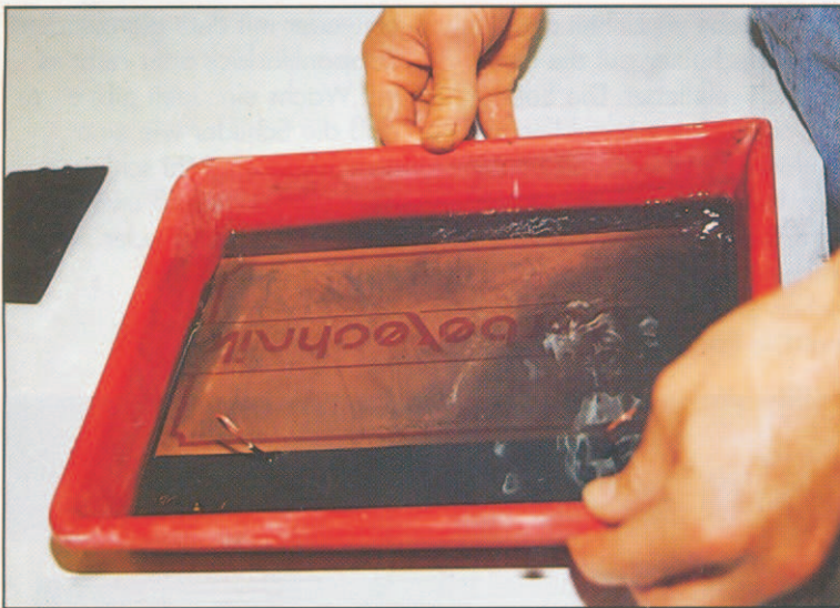
In der heißen Patinalösung nimmt das Schild die endgültige Farbe an
